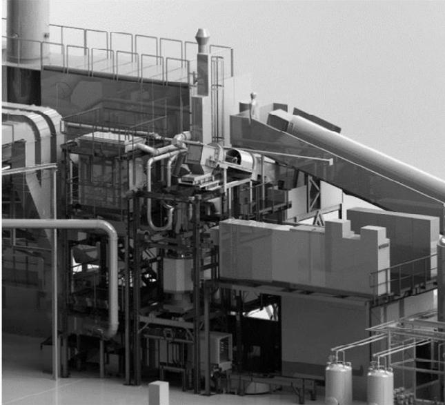
Abb. 2: Schmelzeinheit mit induktiv erhitzten IBE-Inline-Schmelzofen
