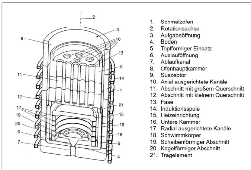
Abb. 1: Konstruktionsprinzip des induktiv erhitzten Inline-Schmelzofens für mineralische Einsatzstoffe
