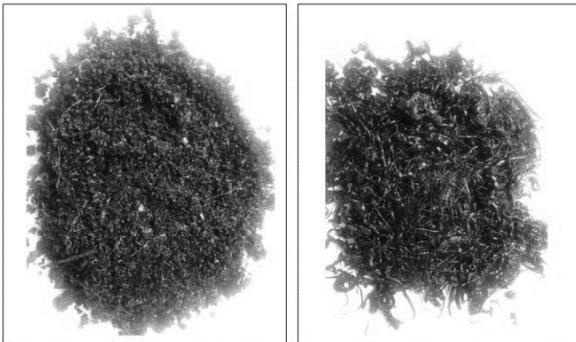
Abb. 5: Naßgranulat und Trockengranulat aus geschmolzenen KMF-Abfällen
