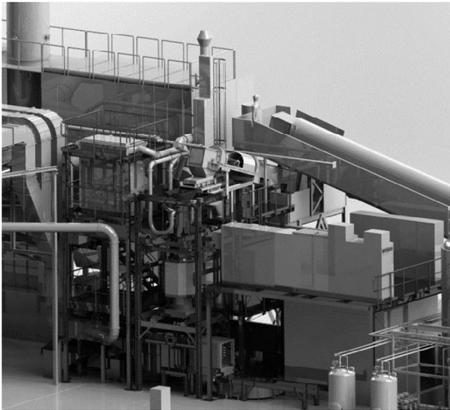
Abb. 2: Schmelzeinheit mit induktiv erhitzten IBE-Inline-Schmelzofen
