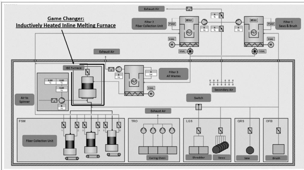
Abb. 3: Stoffkreislauf einer abfallfreien Produktion mit dem IBE-Inline-Schmelzofen
